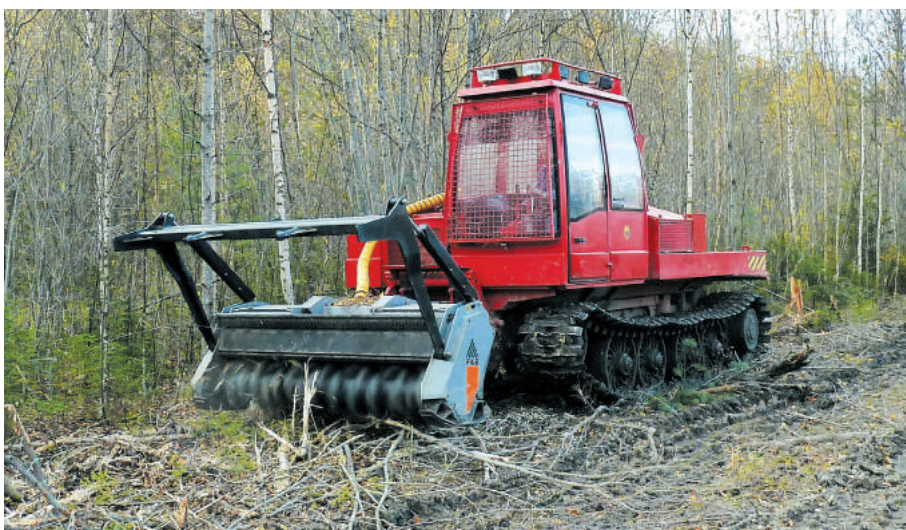
Мульчер «ОТЗ-390» срезает и измельчает растительность до 25 см в диаметре.
